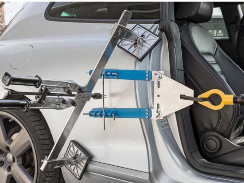
Reparaturmethode für die Karosserieaußenhaut: Mit der AiroPower-Druckluftpresse und den Miracle-Klebebands können beim Richten hohe Kräfte übertragen werden. Bilder: Carbon
