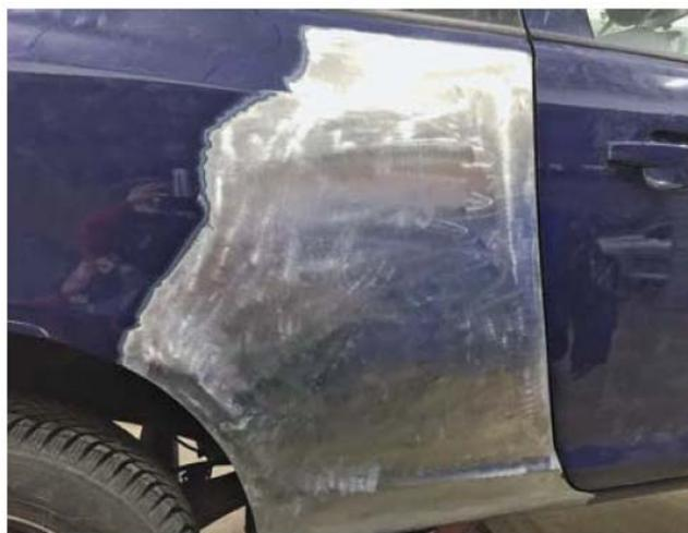
Die Seitenwand ist nach dem Auftrag des UV-Füllers bereit für die Lackvorbereitung.
